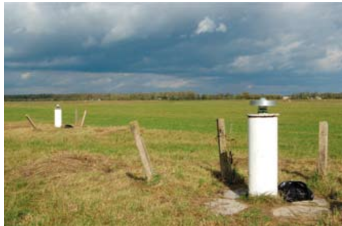
GPS-mittauksia Kyviškės kalibroitiperusviivan ja testikentän pilareilla. Havaintoympäristö on erinomainen satelliittipaikkannukseen. Kuva: Pasi Häkli.
