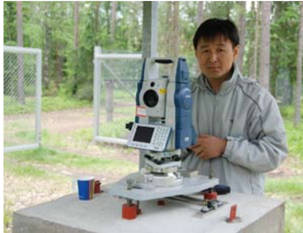
Qingbin Zhai kalibroi Sokkian uutta tarkkuusetaisyysmittaria Nummelan normaaliperusviivalla. Kuva: Jorma Jokela.
