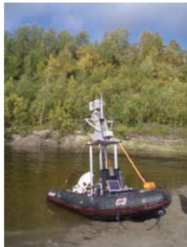
A) Kartoituslaitteisto kumiveneeseen asennettuna Pulmankijoen rannassa. B) Kartoituslaitteisto asennettiin kuljetuskärryyn hiekkasärkkien pinnan kartoitusta varten. Kuvat: Matti Vaaja.
